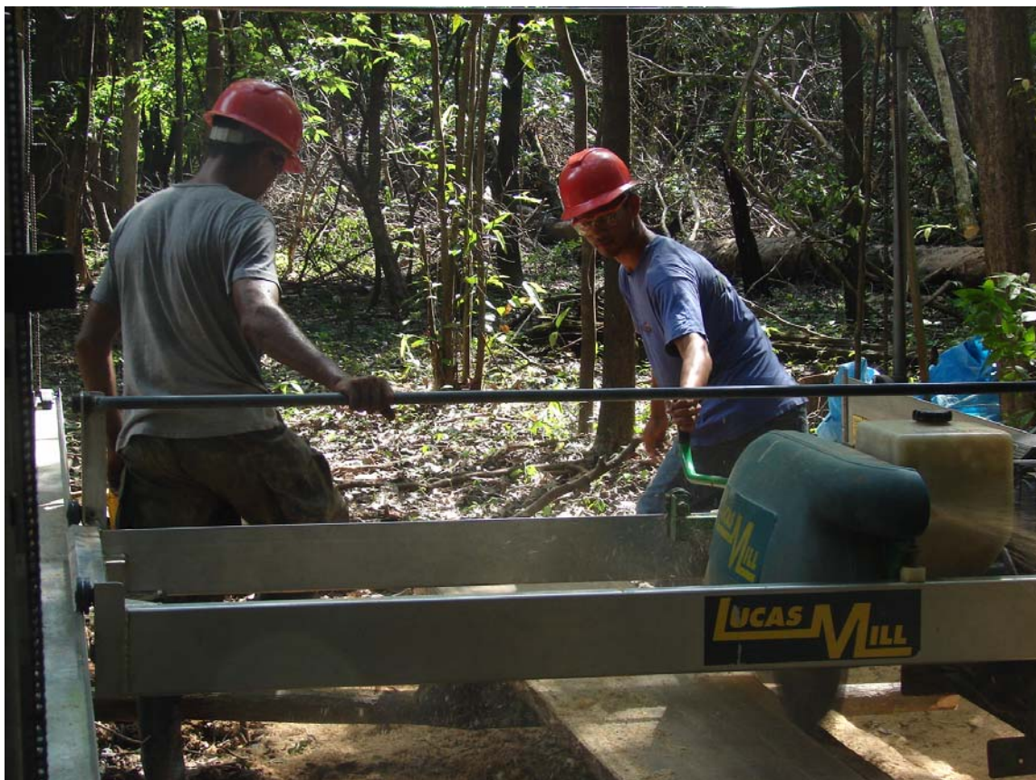
1figura: processamento da madeira com a Lucas Mill.
